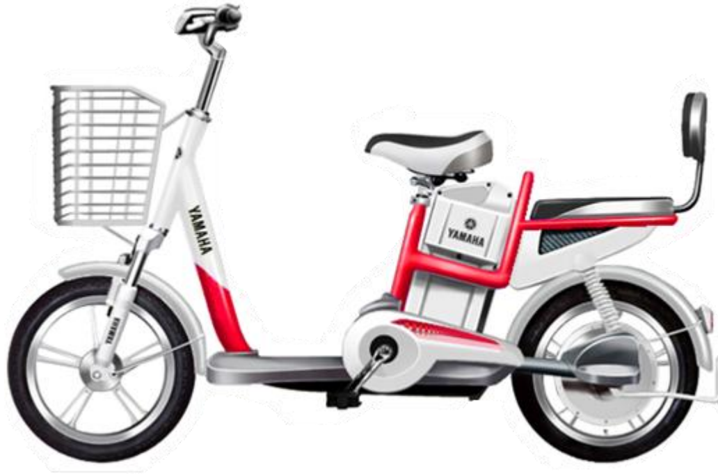
长宽高 1610×610×1045mm 轴距 1140mm 电池容量 48V12Ah
